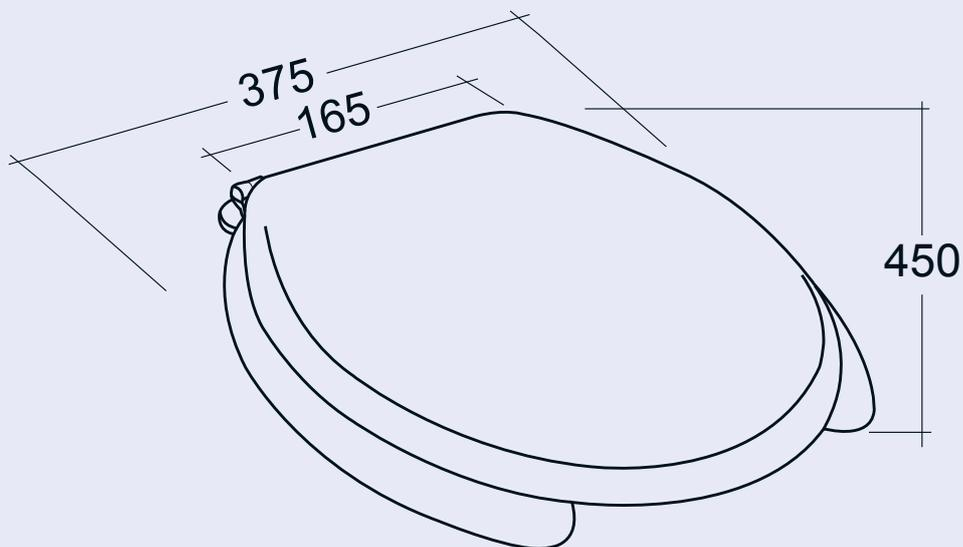
Interasse fori sulla ceramica del vaso mm160/165
